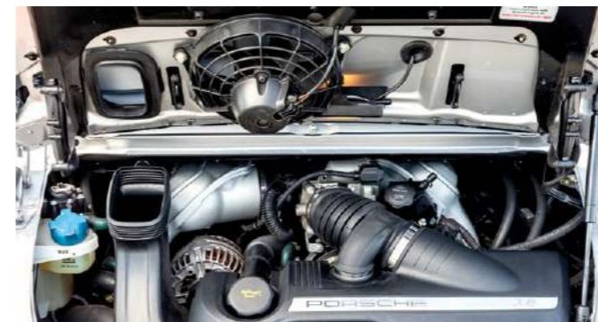
La 997 est avec la première génération de 991, l'une des toutes dernières 911 à moteur atmo. Les versions S et 4S profitent notamment du bloc 3.8 litres, réputé extrêmement solide, à tel point que certains mécaniciens Porsche voient en lui l'héritier moderne du fameux 3.2 litres de la série G.
